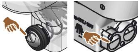
Figur: Justering doseringsplade standard og Twin model på pulverbeholderens udløbsside
